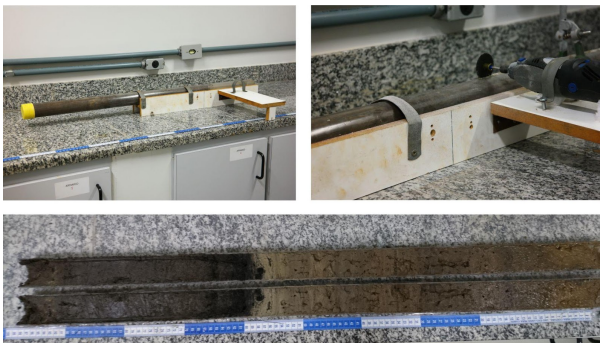
Figura 2- Processo de amostragem(a) perfil no suporte para corte (b) makita para corte posicionada sob bancada (c) perfil de 1m coletado aberto.
